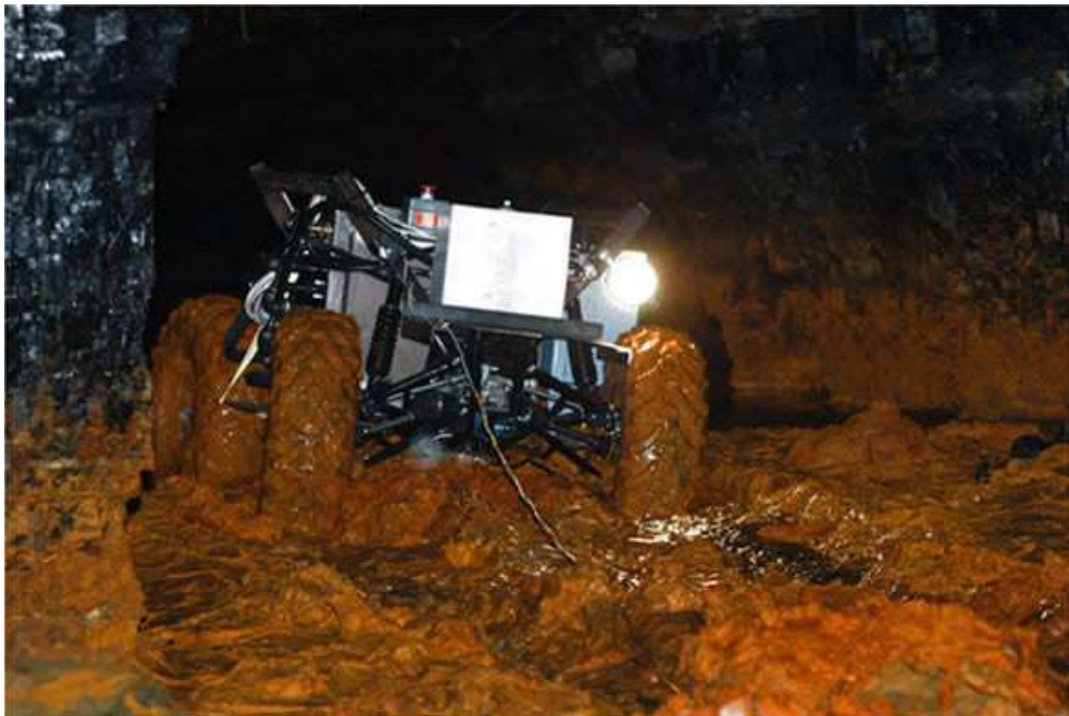
Fig. 61 - O robô Groundhog desenvolvido na da Universidade Carnegie Mellon, em New Jersey, nos Estados Unidos, para exploração subterrânea.
