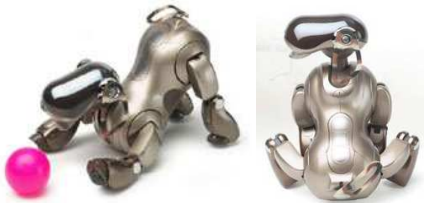
Fig. 5 - O cãozito robótico Aibo da Sony reconhece a voz e a fisionomia do seu dono e obedece a comandos de voz do mesmo.
