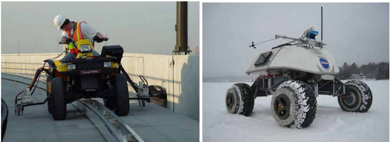
Fig. 59 - Robôs da Universidade Carnegie Mellon, em New Jersey, nos Estados Unidos: Guideway (à esquerda) fazendo inspeção nos carris no Aeroporto Internacional de Fort Worth, em Dallas, nos Estados Unidos e Lorax (à direita) em actividade na Antárctica.
