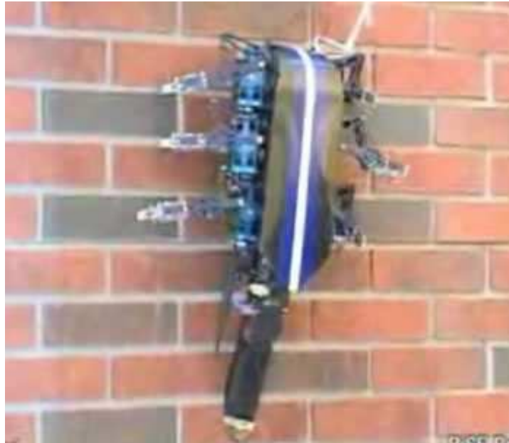
Fig. 64 - O robô RiSE , da Bóston Dynamics, também sobe na vertical em paredes de tijolos.
