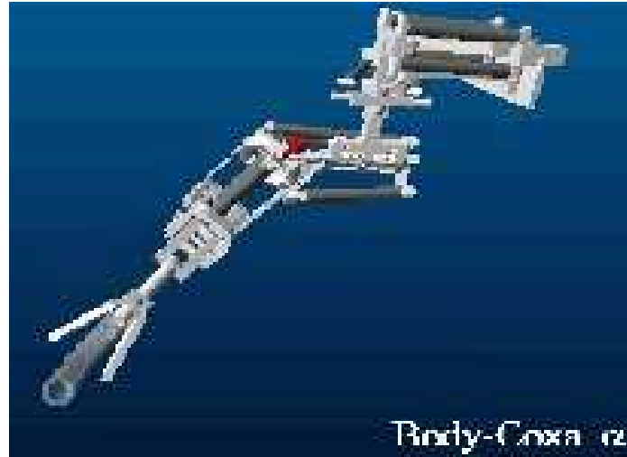
Fig. 127 - Uma pata do robô barata Ajax com suas diversas juntas articuladas que dão no total 24 graus de liberdade.
