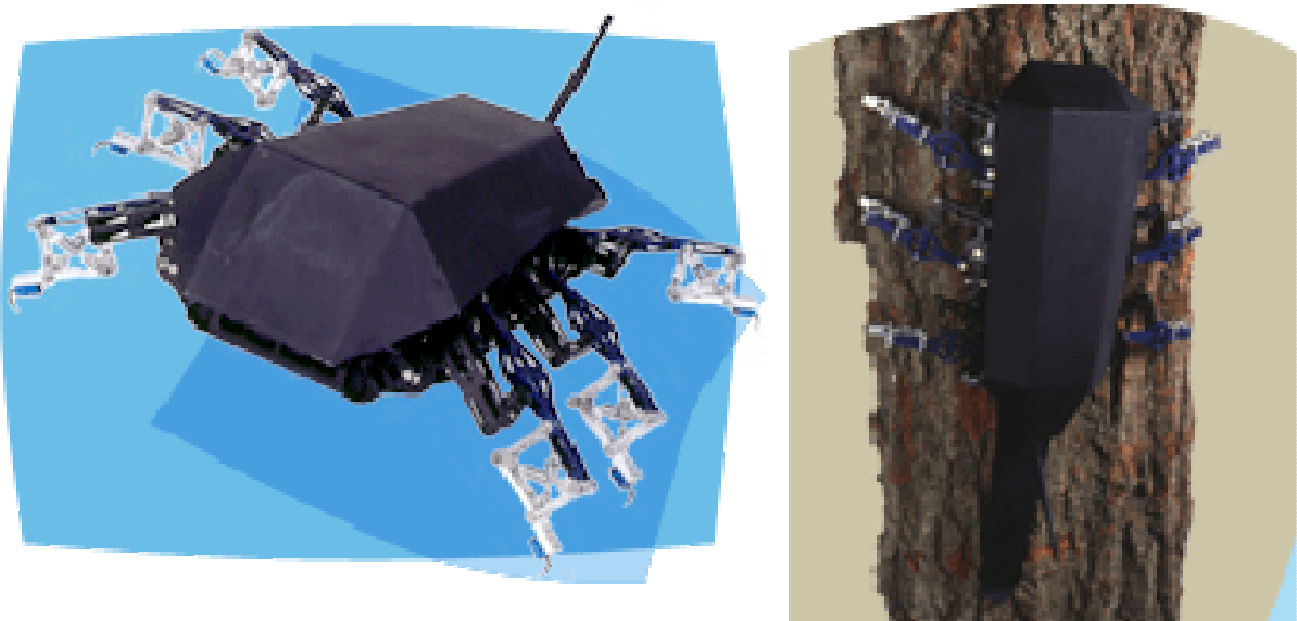
Fig. 63 - O robô RiSE , da Bóston Dynamics, também sobe na vertical em árvores.
