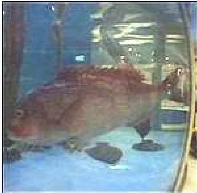
Fig. 85 - Peixe robô submarino “ sea bream ” que reproduz um peixe extinto, recriado à partir de fósseis. Peso: 2.5 kg e comprimento: 50cm. Atinge a velocidade máxima de meio nó (0.9 km/h). Sua bateria pode mante-lo nadando por até 30 minutos.
