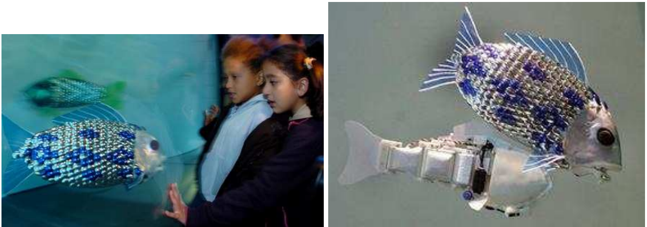
Fig. 76 - Robôs peixe (“ robotfish ”) da Universidade de Essex em um aquário. Na figura da direita um deles está sem a sua capa de escamas.
