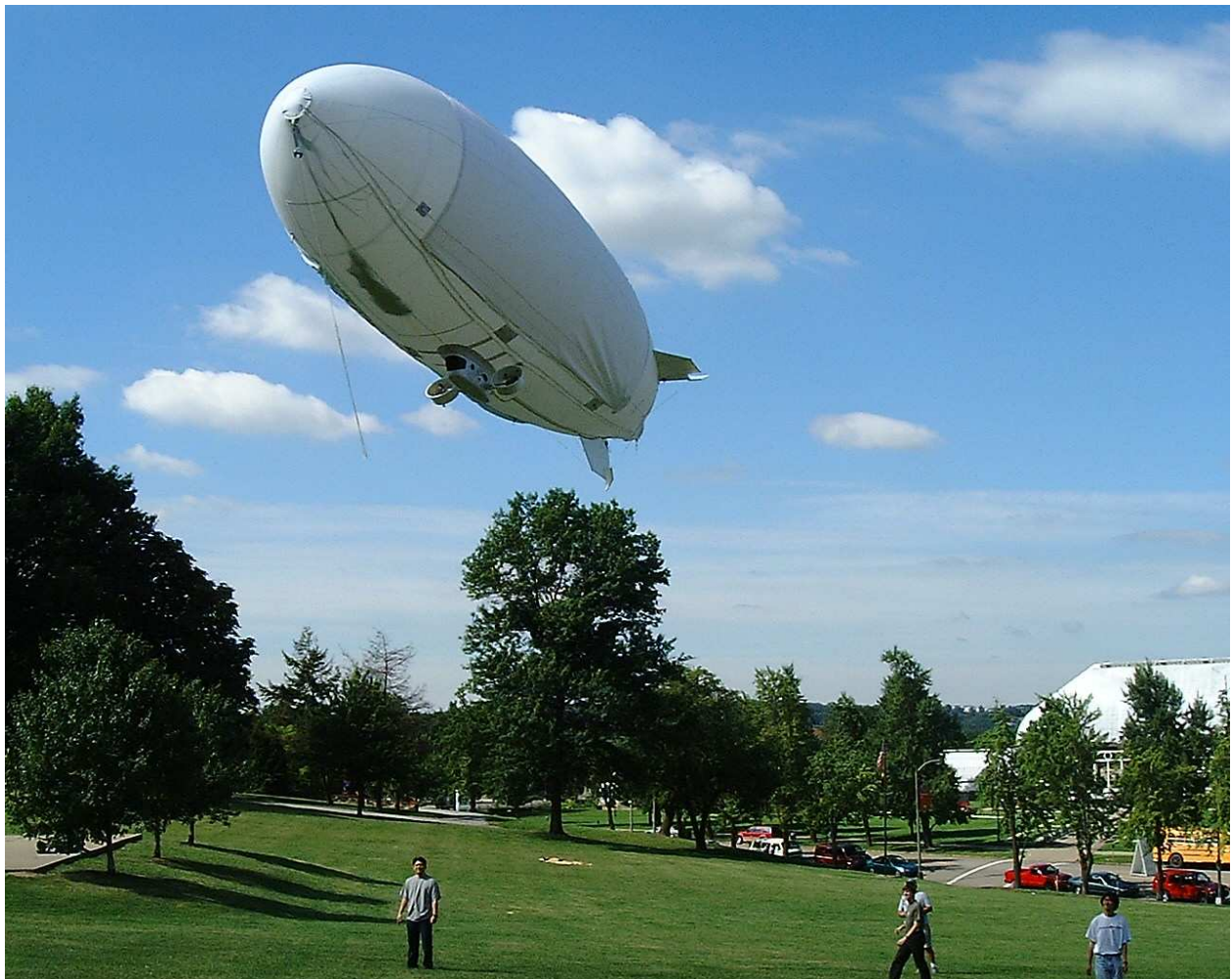
Fig. 133 - O robô Enviroblimp desenvolvido na da Universidade Carnegie Mellon, em New Jersey, nos Estados Unidos. Usa energia solar e colecta dados para previsão meteorológica.
