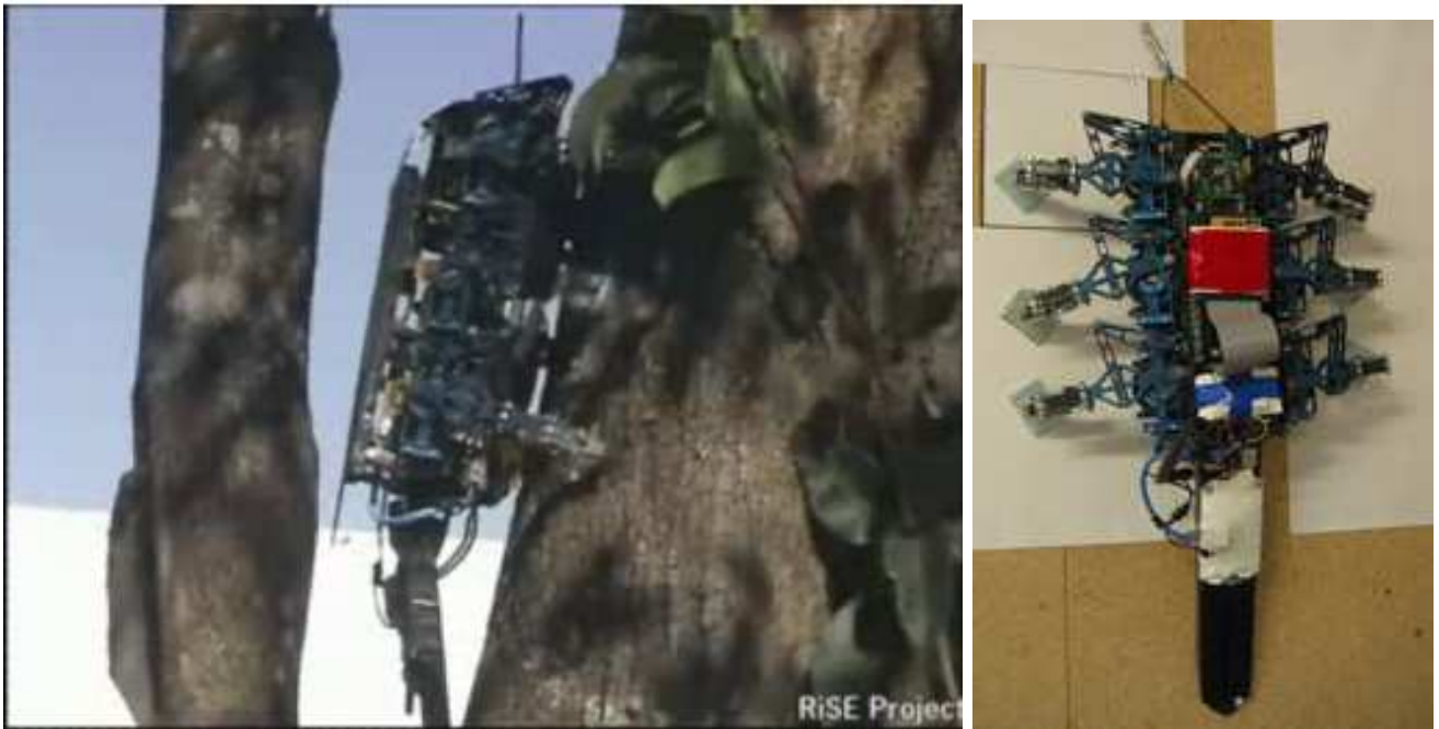
Fig. 62 - O robô RiSE da Bóston Dynamics, que sobe em paredes, em árvores, etc.
