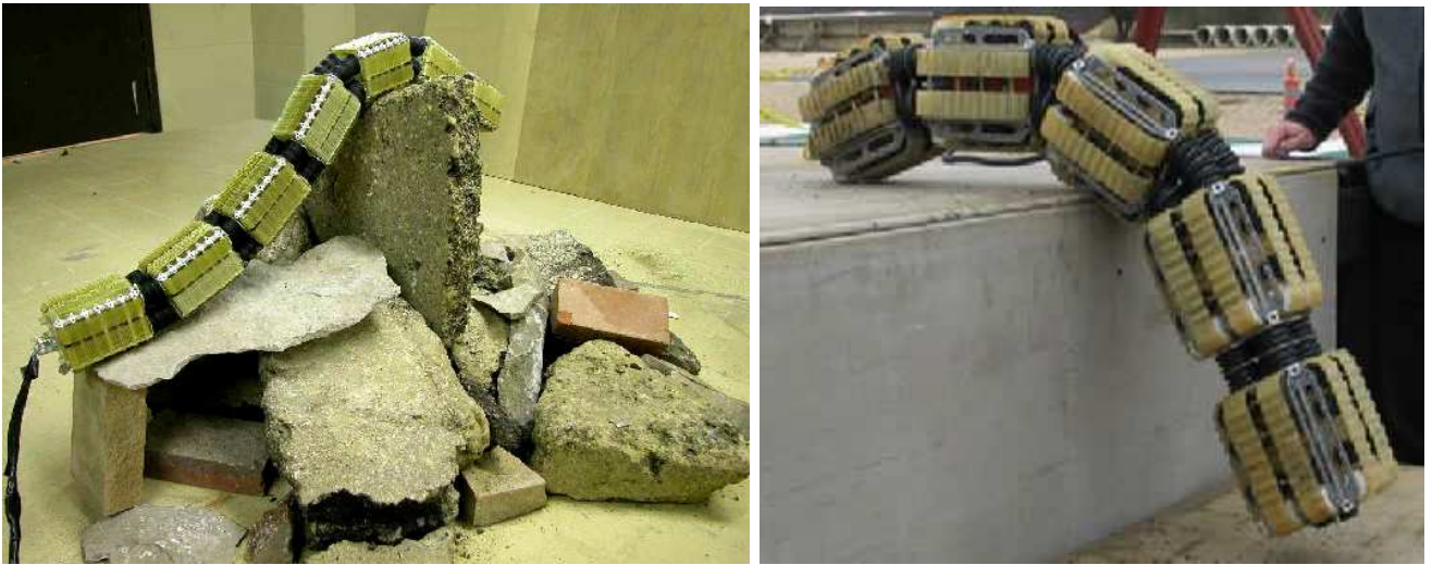
Fig. 29 - OmniTread , o robô cobra (“ snake robots ”) que parece ser composto por contas como num colar ou por vagões como num comboio.
