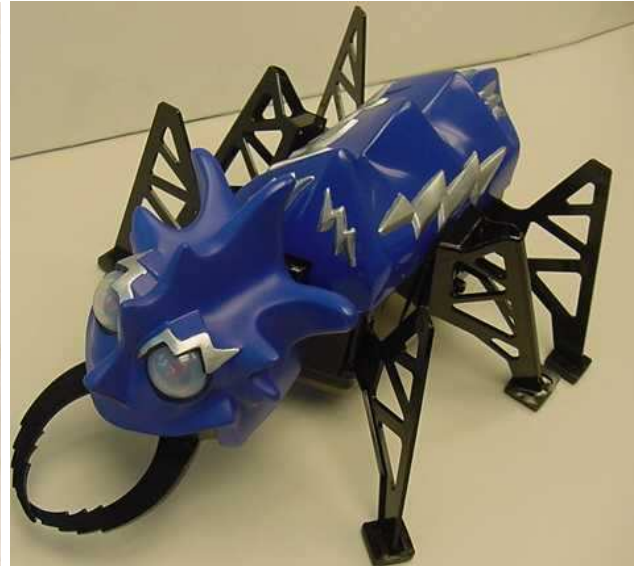
Fig. 92 - O Robobug outro robô aranha ( spider robot ) com 6 patas da Mechatrinix com sua capa que o deixa com o aspecto de um bicho ou insecto tipo besouro .
