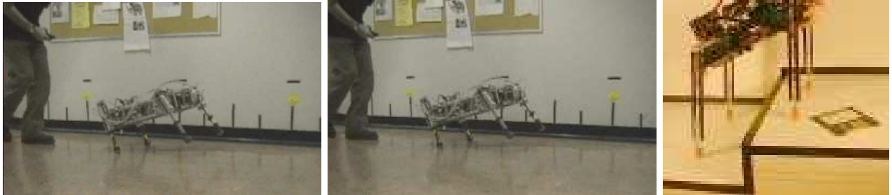
Fig. 41 - O robô Scout II galloping é capaz de andar, correr, galopar, fazer curvas, e até subir escadas.
