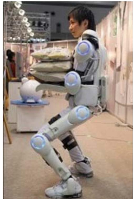
Fig. 72 - O *robô HAL*, criado na Universidade de Waseda no Japão. Um fato que está sendo usado por um homem para levantar um peso 30kg.
