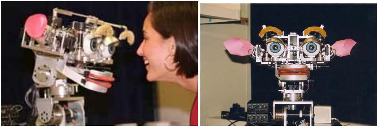
Fig. 76 - *Kismet* do MIT (*Massachusetts Institute of Technology*), um robô desenvolvido para comunicação e aprendizado à maneira humana.
