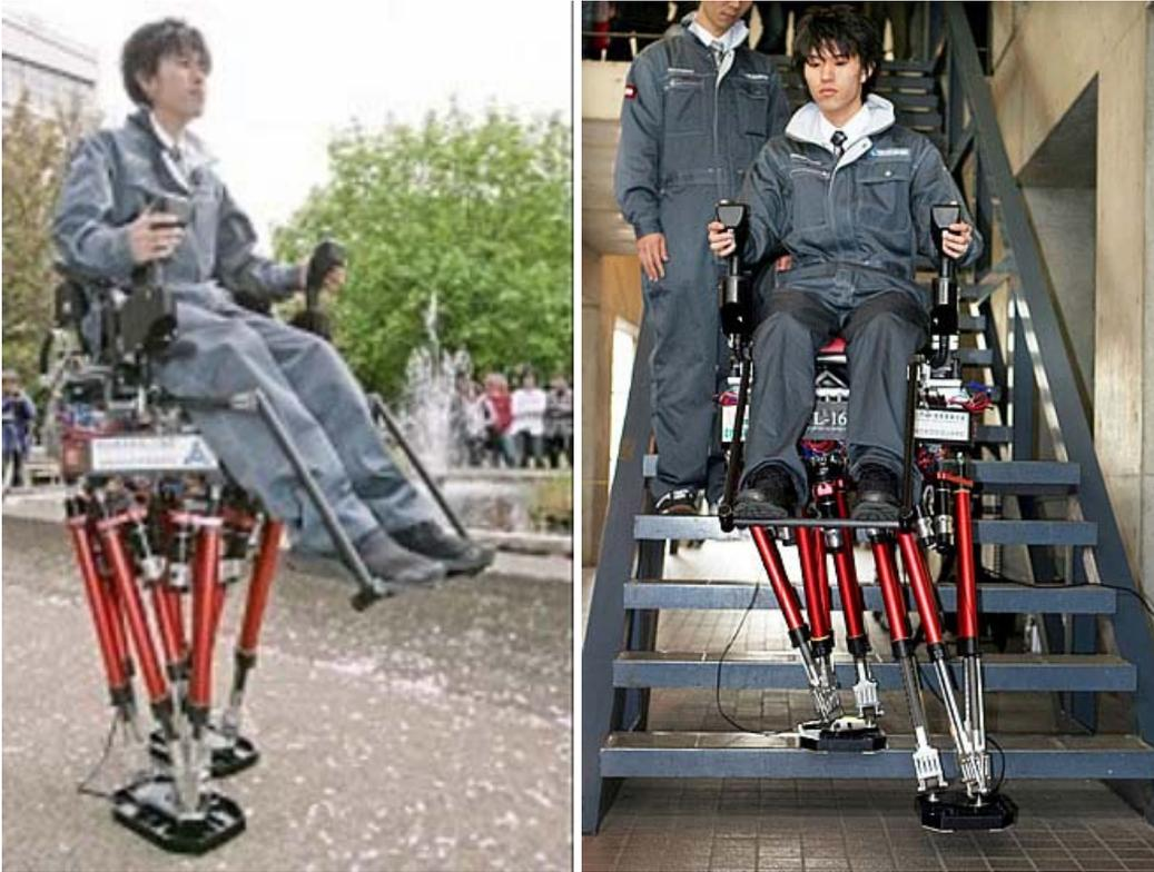
Fig. 71 - Projecto de *robô bípede*: o *WL-16III Walkbot*, criado na Universidade de Waseda no Japão para ajudar a deficientes e idosos a caminharem e subir escadas.
