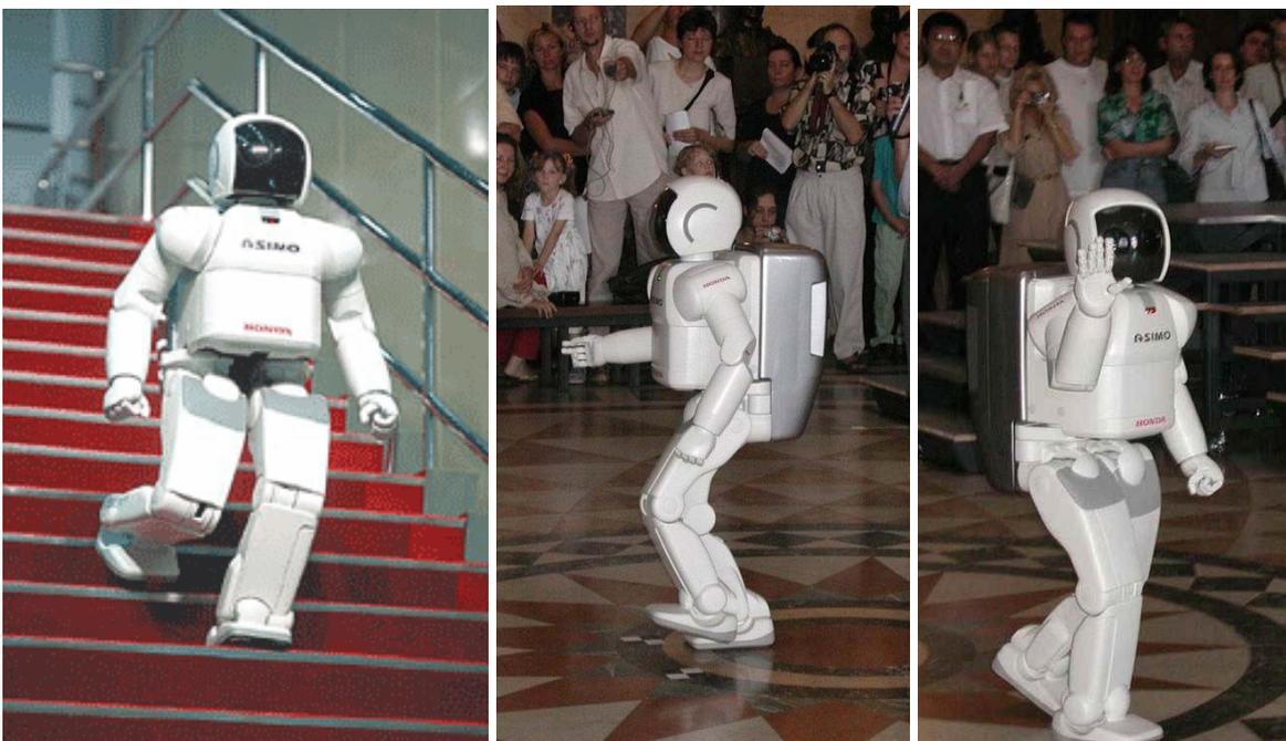
Fig. 11 - *Asimo*, o *robô humanóide* da Honda.
