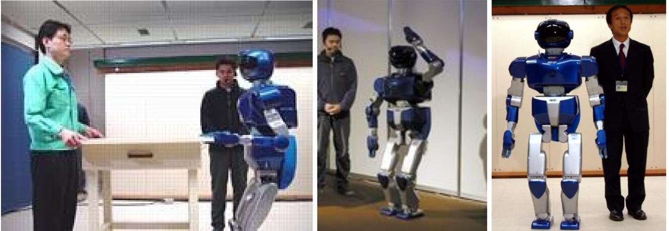
Fig. 29 - *HRP-2P*, um *robô humanóide* da Kawada Industrial Corp. e Universidade de Tóquio a executar trabalhos em ambientes industriais. Ele tem a estatura de um homem baixo.
