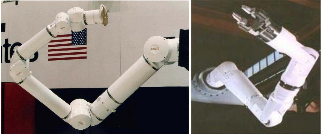
Fig. 6 - O sofisticado *braço manipulador robótico* do *space shuttle* (*vaivém espacial*), também chamado de *Canadarm*, que tem 6 graus de liberdade.
