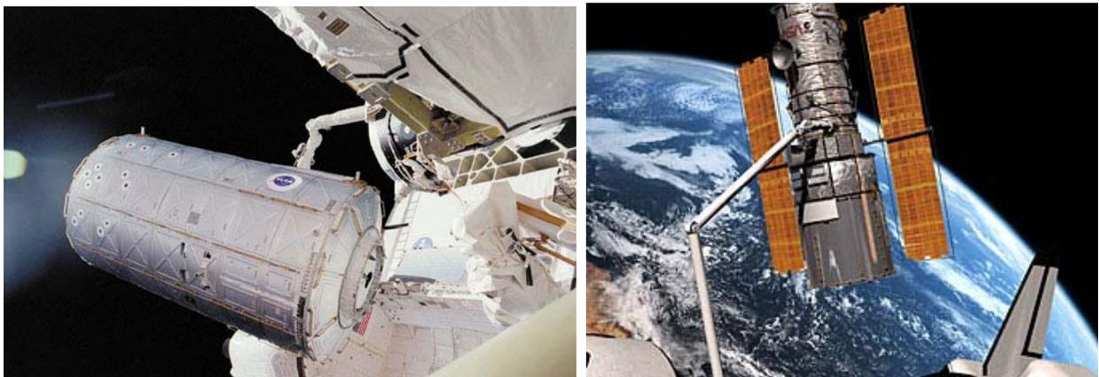
Fig. 7 - O *braço manipulador robótico* do *space shuttle* colocando um satélite em órbita (à esquerda) ou reparando o telescópio Hubble (à direita).
