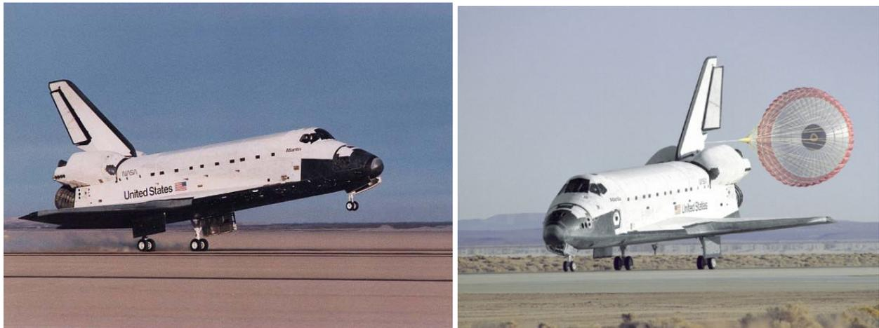
Fig. 4 - O '*space shuttle*' (*vaivém espacial*) aterra como um avião normal, mas usa para quedas na fase final da aterragem.
