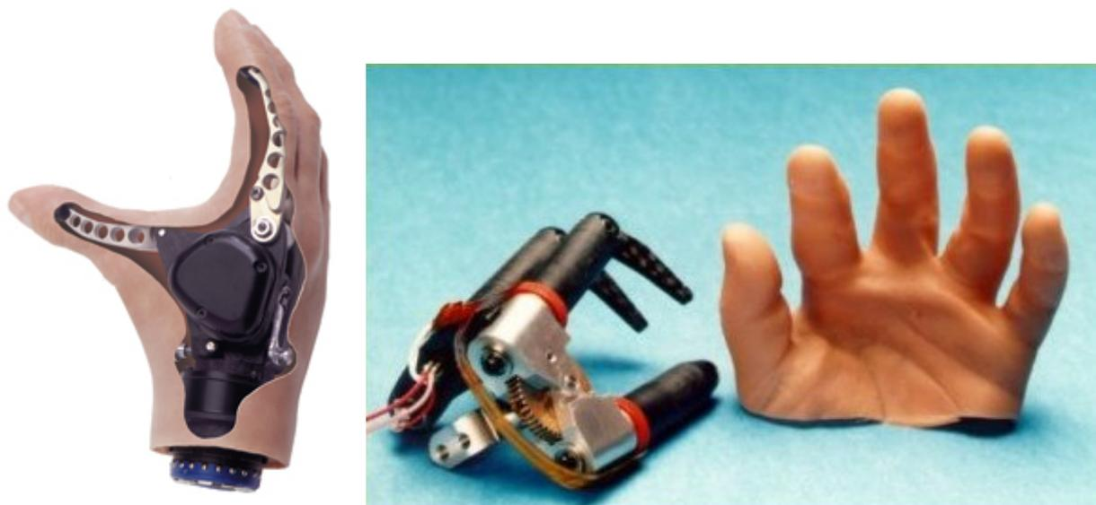
Fig. 9 - Mãos artificiais robóticas (mãos biônicas).
