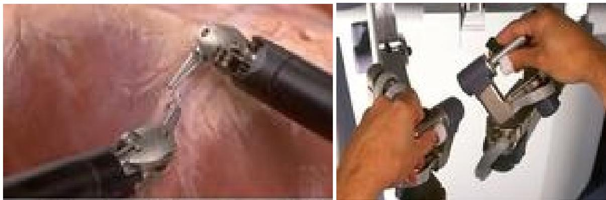
Fig. 13 - O cirurgião move o *robô* usando os controlos remotamente. As ferramentas minúsculas na ponta do braço robótico movem-se acompanhando os movimentos da mão humana mas têm a capacidade de filtrar os tremores desta.
