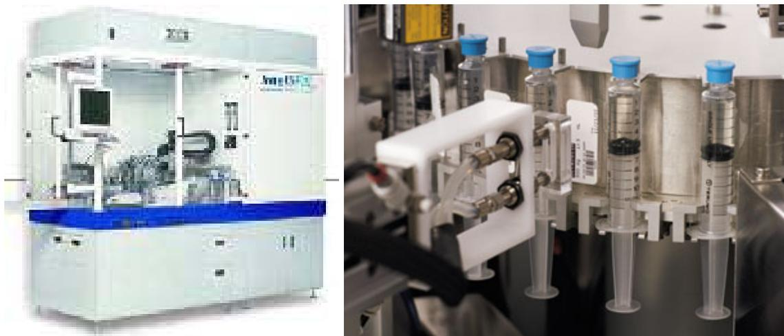
Fig. 4 - *Robô IntelliFill* da *ForHealth Technologies Inc.* empregado para preparar receitas em hospitais.
