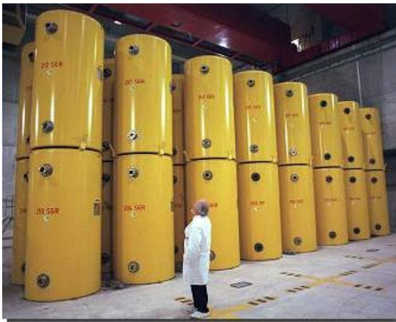
Fig. 61 - *Plutônio*, elemento radioativo que é usado no processo de gerar energia nuclear, antes de ser usado. Ele foi embalado por *robôs* em *containers* blindados.
