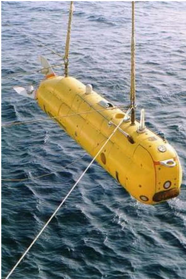
Fig. 31 - À esquerda o *MT-98*, um AUV robótico do IMTP (Instituto de Tecnologia Marinha) em Vladivostok, na Rússia. Antes de submergir para uma operação de busca e salvamento.
