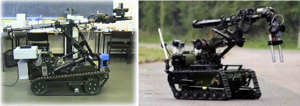
Fig. 37 - O *Wheelbarrow*, um *robô* britânico que desmonta bombas ou minas.
