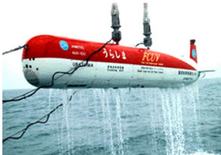
Fig. 33 - O *AUV robótico Urashima*, desenvolvido para explorar partes profundas do oceano pelo JAMSTEC (Centro de Ciência e Tecnologia Marinha do Japão).
