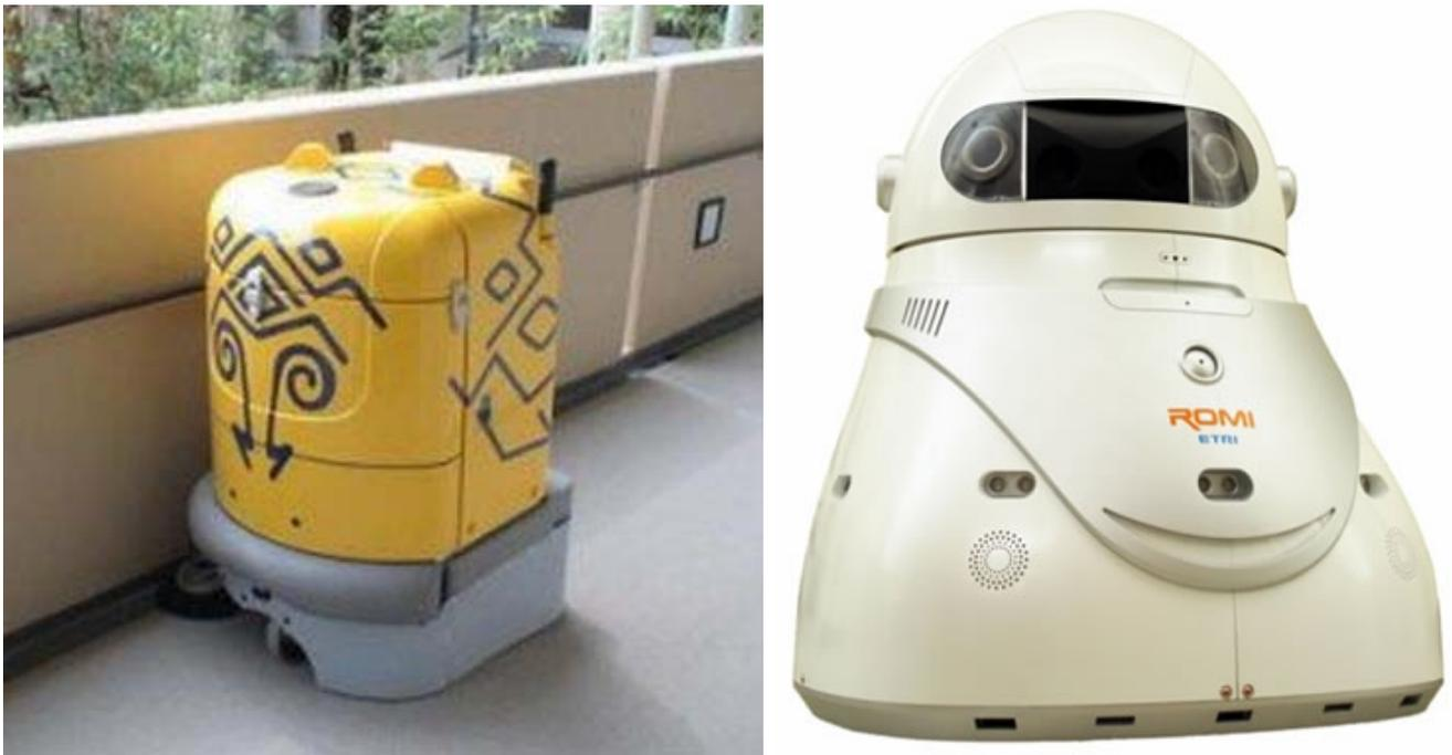
Fig. 2 - **Robôs** domésticos de limpeza que aspiram o chão. **Tondon** (à esquerda) e **Romy** (à direita).
