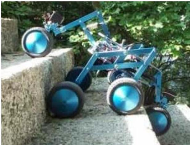
Fig. 20 - O “*Shrimp*”, *robô* desenvolvido na Suíça pela EPFL.
