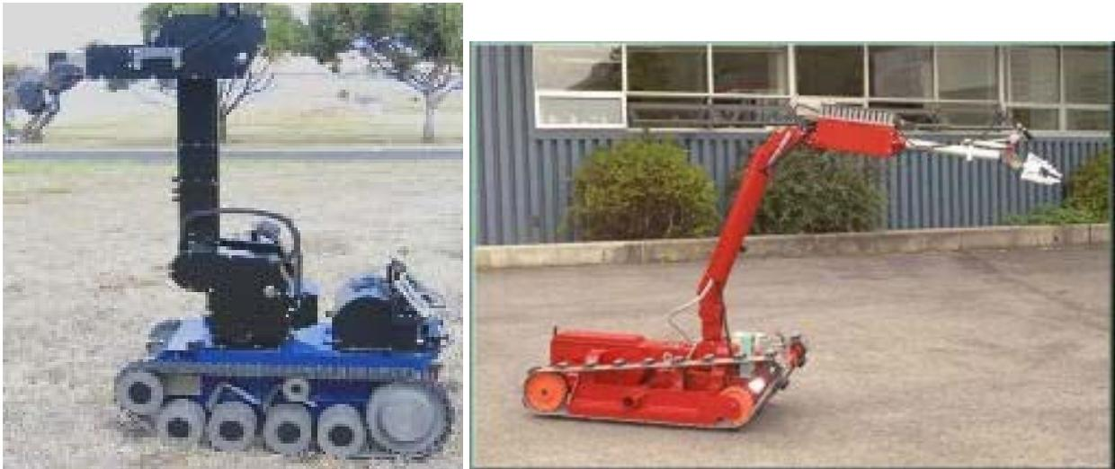
Fig. 45 - Theodore (à direita), um *robô* policial que detecta bombas e MERV (à esquerda), um *robô* que retira bombas e leva para um lugar seguro para serem eliminadas.
