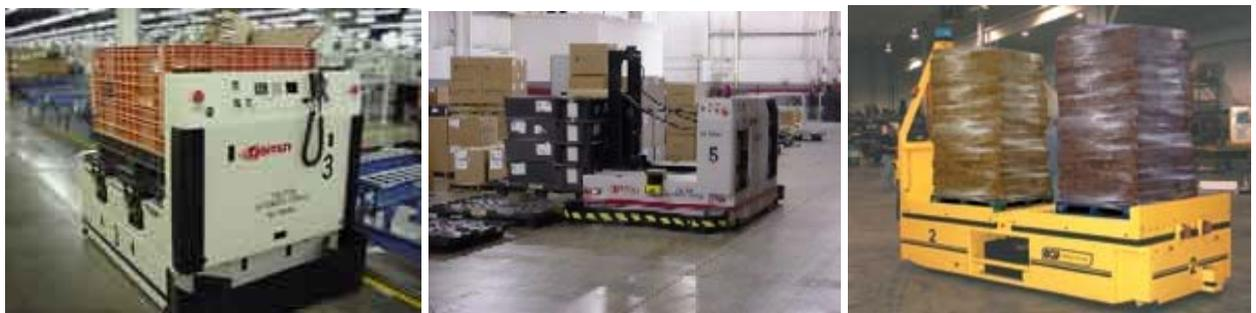
Fig. 16 - *AGV's* (*Automated Guided Vehicles*) fazendo o transporte de materiais na indústria.
