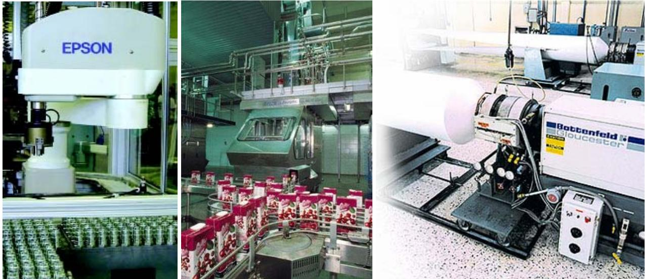
Fig. 9 - Alguns **robôs** na indústria **alimentícia** e de **bebidas**, fase de **empacotamento**.
