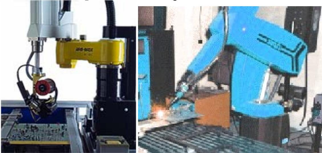
Fig. 2 - *Robôs* na linha de produção fazendo soldadura.
