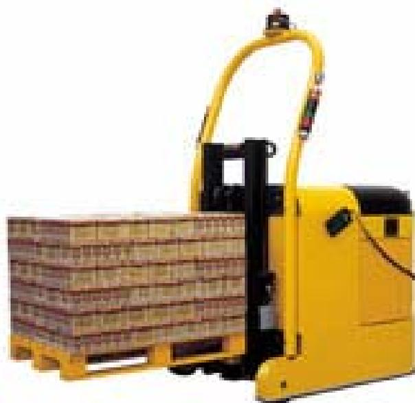
Fig. 18 - Um **LGV** (*Laser Guided Vehicle*) e um **AGV** (*Automated Guided Vehicles*) fazendo o transporte de materiais na indústria.
