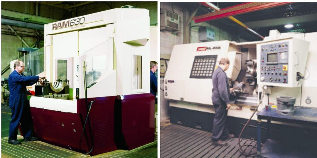
Fig. 19 - Máquinas **CNC** (*Computer Numeric Control* ou *Controle Numérico Computorizado*) na indústria.
