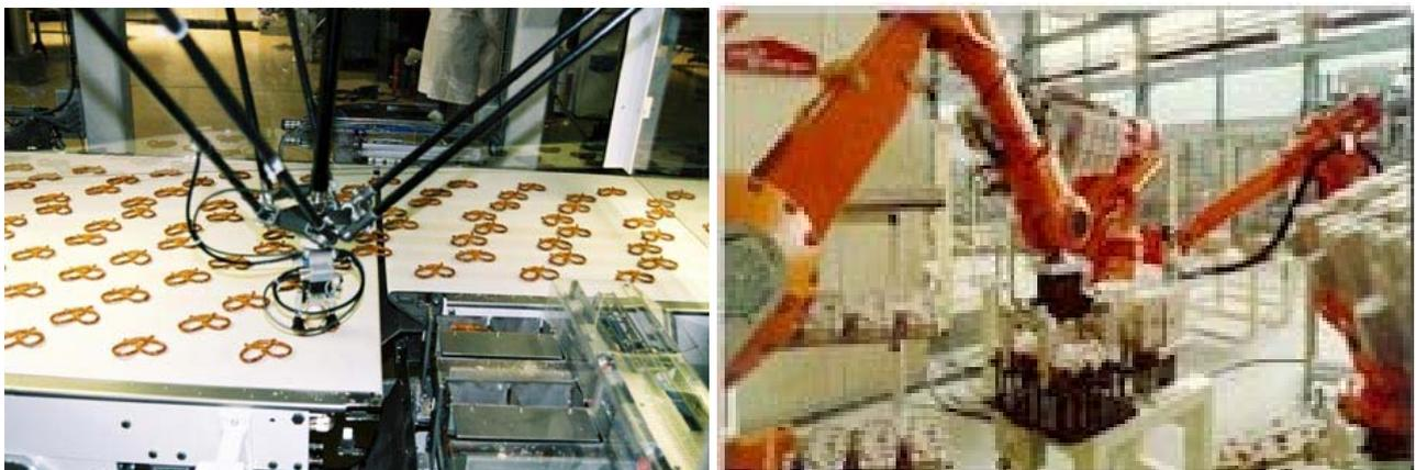
Fig. 6 - *Robôs* na indústria *alimentícia* (à esquerda) e na indústria de *bebidas* (à direita).
