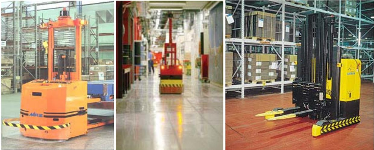
Fig. 17 - **LGV's** (*Laser Guided Vehicles*) fazendo o transporte de materiais na indústria.
