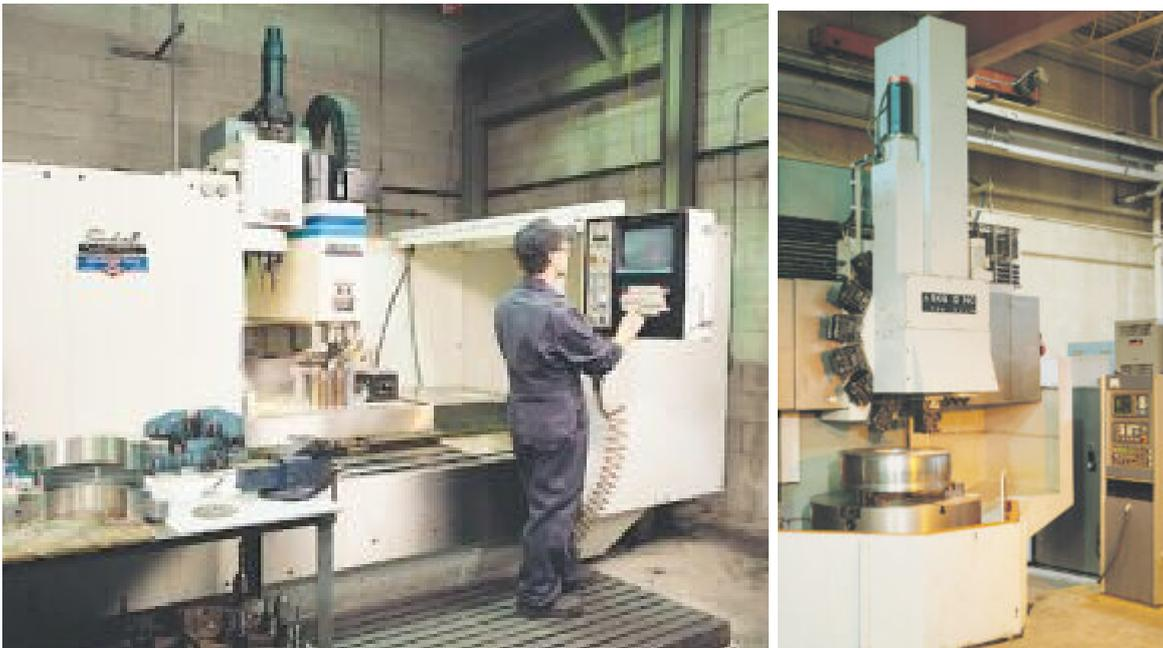
Fig. 22 - Máquinas **CNC** (*Computer Numeric Control* ou *Controle Numérico Computorizado*) na indústria.
