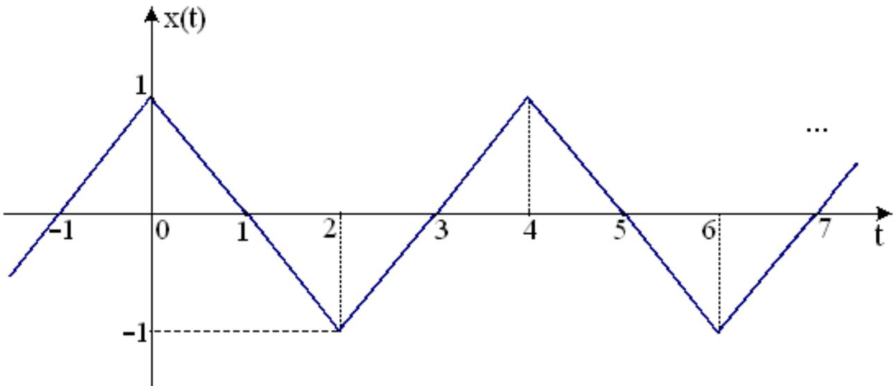
2) – Para o sinal periódico  $x(t)$  abaixo ache a expressão de todos os *coeficientes* da **série trigonométrica de Fourier** (i.e.,  $a_k$  e  $b_k, \forall k$ ). Calcule então os 9 primeiros termos desta **série trigonométrica de Fourier** de  $x(t)$ .
