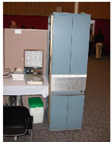
Fig. 28 - O PDP-5, o primeiro minicomputador comercial.
