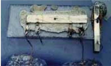
Fig. 24 - O primeiro *circuito integrado* (Texas Instruments, EUA, 1958).
