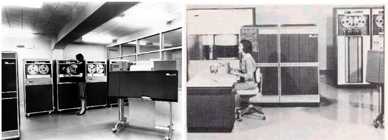
Fig. 21 - O IBM 1401, lançado em 1960, um computador de segunda geração.
