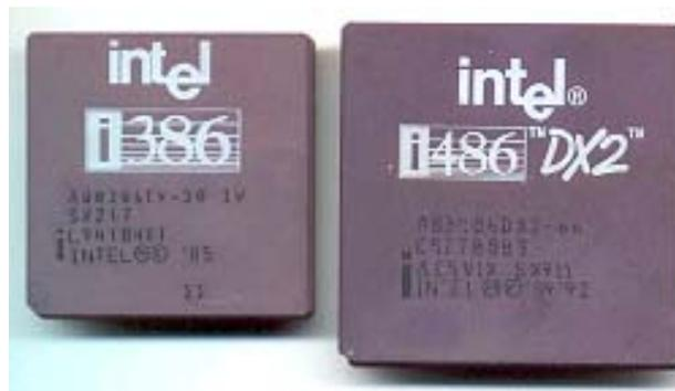
Fig. 36 - Os *microprocessadores* Intel 386 e 486.
