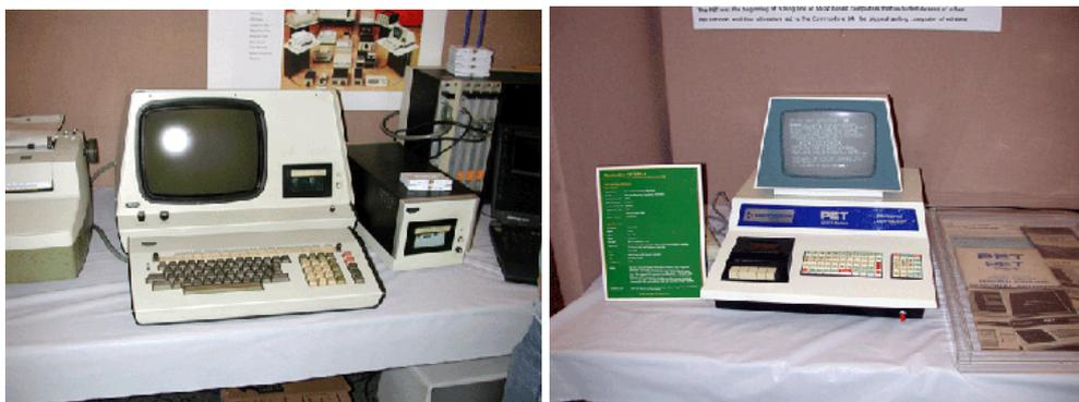
Fig. 33 - Dois *microcomputadores* do início da quarta geração: o Wang 2200 de 1973 (à esquerda) e o PET 2001, de 1977 (à direita).
