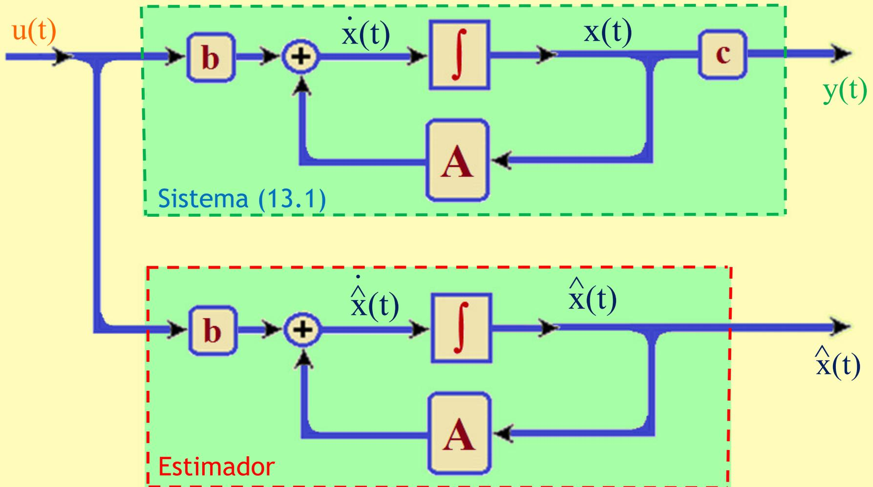
Um **estimador de malha aberta** para o sistema (13.1), ilustrado acima, consiste em simular analiticamente o sistema **físico** real e obtendo-se assim uma **estimativa**  $\hat{x}(t)$  para o estado real  $x(t)$ .
