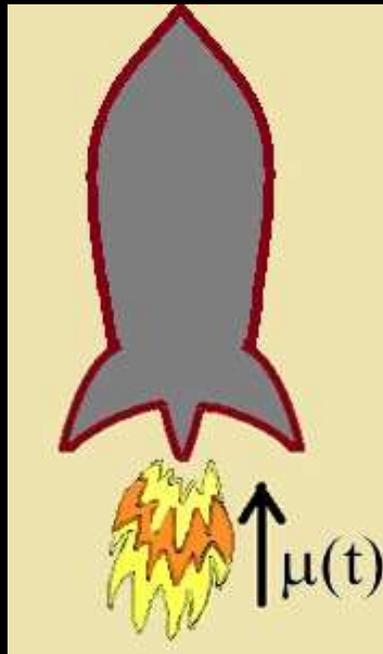
$\mu(t)$  = controle (input) = empuxo ('*thrust*') aplicado ao foguete
