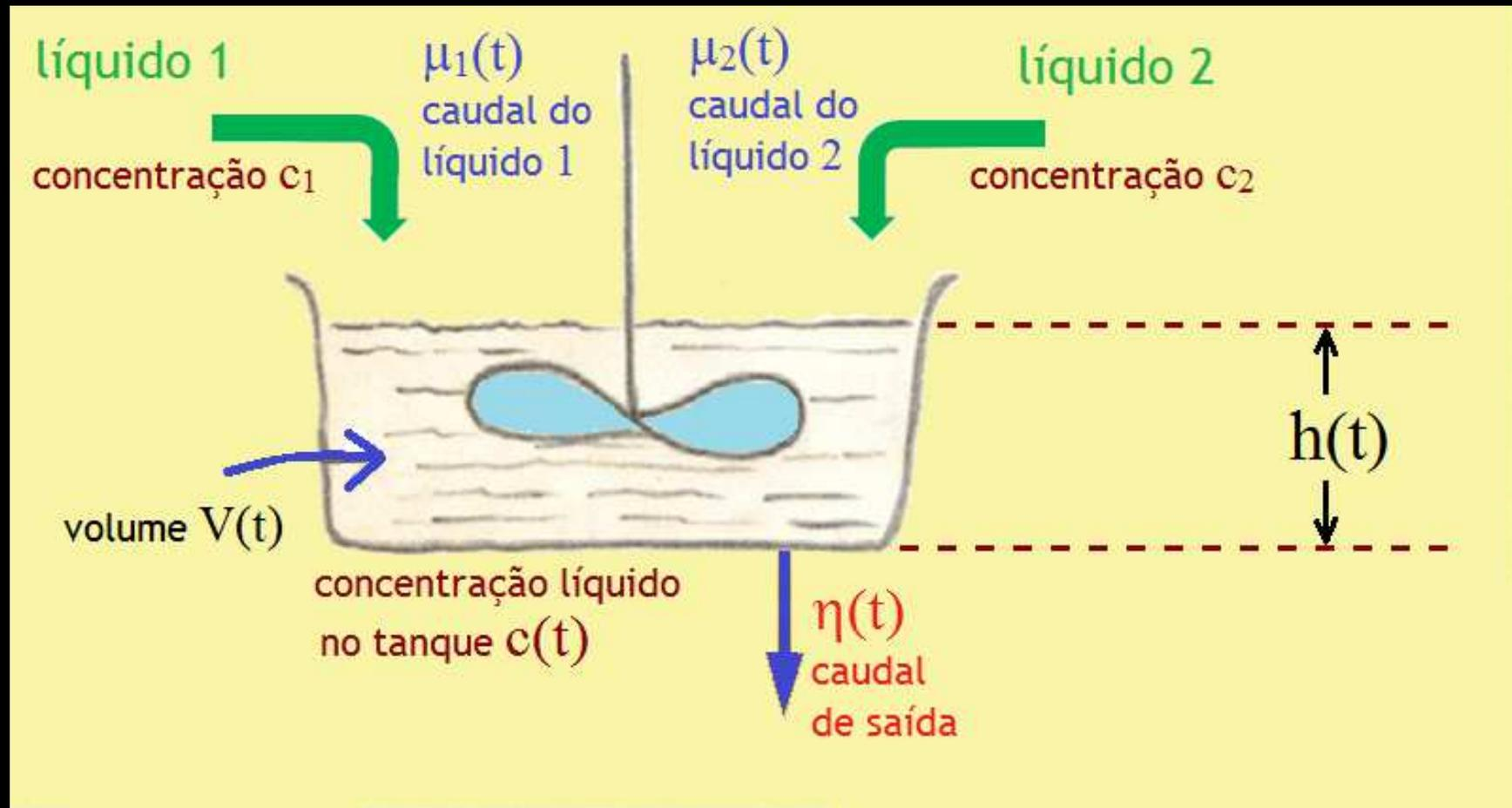
Este tanque mistura o líquido 1 (de concentração  $c_1$ , constante) com o líquido 2 (de concentração  $c_2$ , constante).
