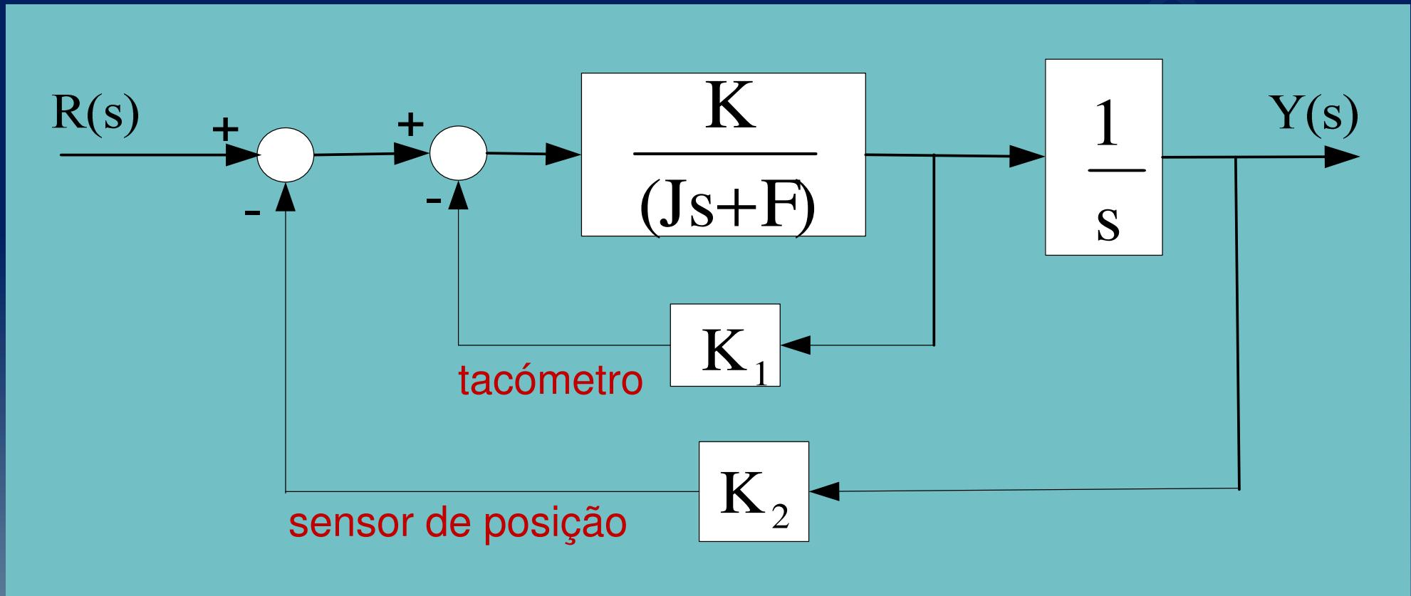
para servomotores com realimentação de velocidade
